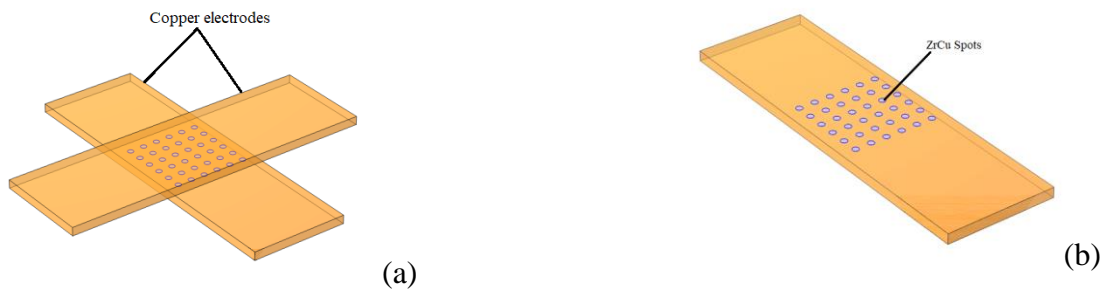
Fig. 3.8. Modelul geometric (modelul IV) care arată: (a) electrozii de cupru, (b) punctele de ZrCu pe suprafața de contact.
