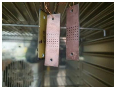
Fig. 6.5. Eșantioane de contact îmbătrânite în prezența unei soluții de clorură de sodiu (NaCl) în cuptorul cu aer forțat.
