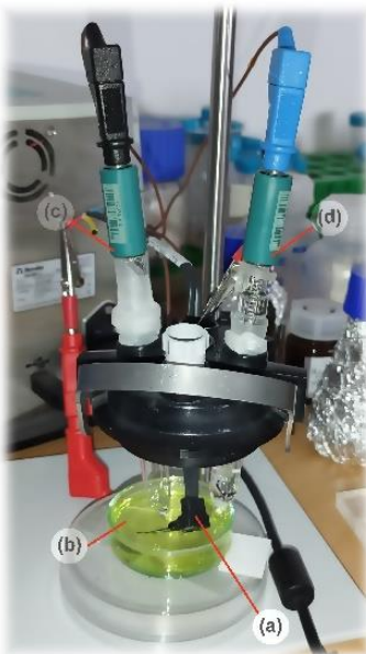
Fig. 5.2. Suport pentru celula cu 3 electrozi: a) Electrod (WE) imprimat 3D; b) Soluție redox; c) Electrod auxiliar/counter (CE); d) Electrod de referință (RE) [54] .
