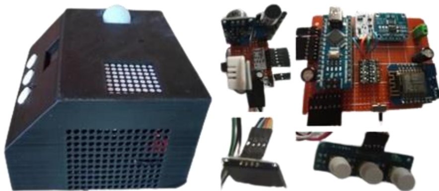
Figura 3.36. Dispozitivul prototip de monitorizare ambientală complet asamblat (stânga) și circuitul său intern (dreapta)
