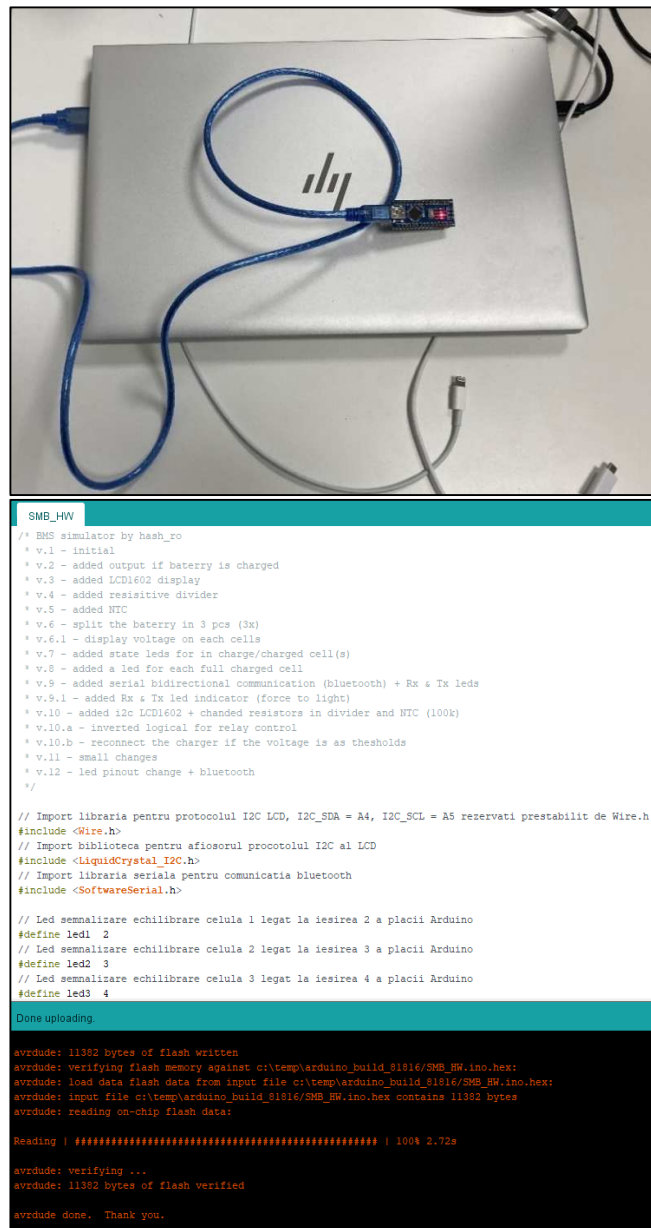
Fig. 3.35. Descărcare aplicația de control pe placa de dezvoltare Arduino Nano 3.0
