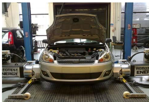
Fig. 4.3 Dinamometrul șasiului atașat la roțile din față ale mașinii [84, 86] cu: puterea maximă de 100 kW pe care o poate produce și absorbi vehiculul, cuplul maxim de 2500 Nm instantaneu și 1180 Nm continuu, viteza maximă a butucului de 2100 rpm (echivalent cu viteza maximă a vehiculului de 250 km/h)
