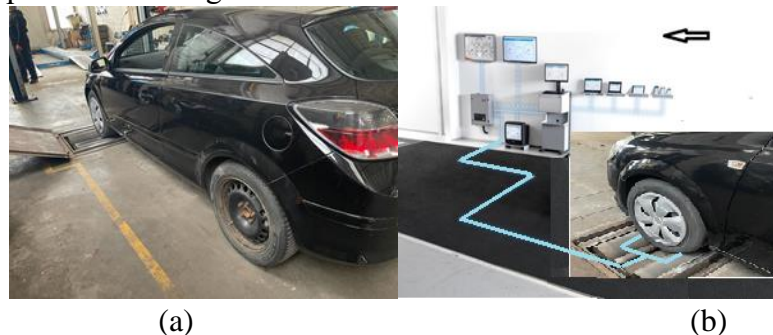
Fig. 5.10 Testarea sistemului de frânare pe puntea din față - proba 1: (a) plasarea autovehiculului pe stand; (b) modul de culegere a informațiilor/semnalelor și transmiterea la baza de date
