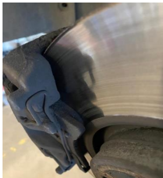
Fig. 5.5 Zgârieturi și urme de uzură prezente pe suprafața discului de frână
