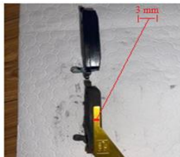
Fig. 6.5 Măsurarea gradului de uzare al plăcuței de pe puntea din spate
