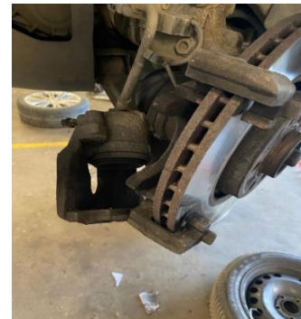
Fig 5.6 Disc de frână cu urme de rugină
