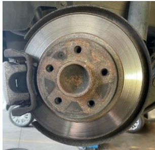
Fig. 6.4 Disc de frână uzat
