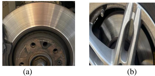
Fig. 6.12 Gradul de uzare a discurilor de frână a) disc de frână original b) disc de frână aftermarket
