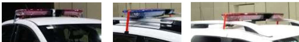
Figura 23 Amplasarea dispozitivului de avertizare luminoasă
