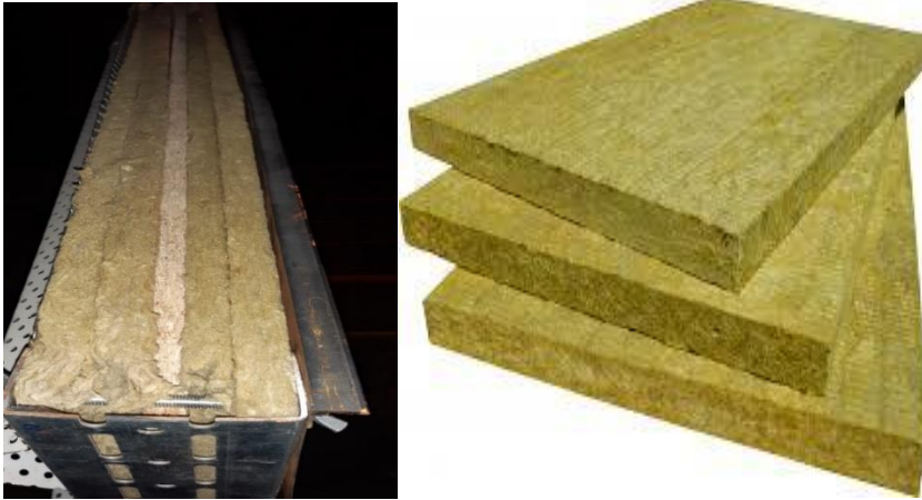
Figura.2.7- Tipuri de materiale utilizate pentru absorbția acustică – b) vată bazaltică [B.G.20; B.G.21].
