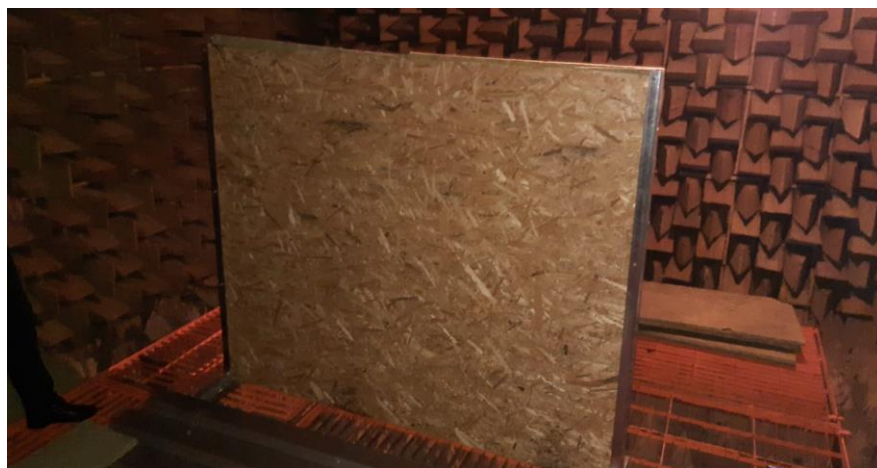
Figura.2.5- Detaliu de structura a barierei acustice
