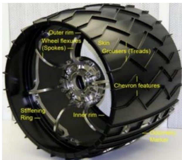
Figura 1.1. Roată Curiosity din aliaj de aluminiu 7075-T7351 [125].
