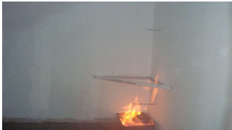
Fig. 20. Imagine după 30 de secunde de refulare a apei în incintă, la temperatura apei pentru suprimare de 15 °C
