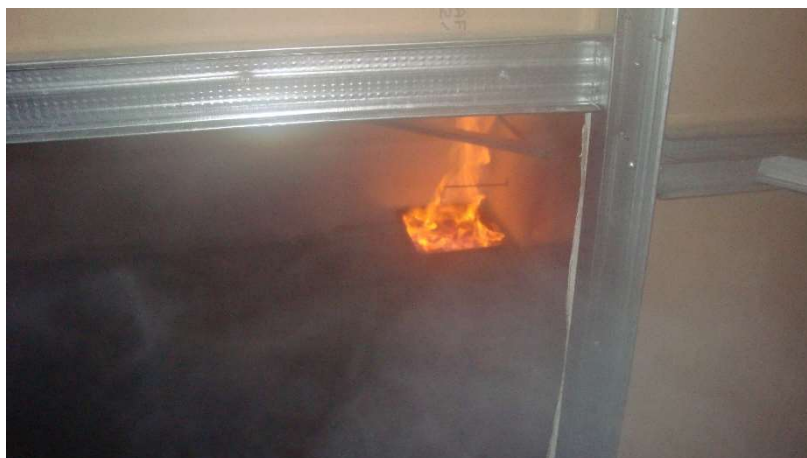
Fig. 21. Imagine după 30 de secunde de refulare a apei în incintă, la temperatura apei pentru suprimare de 30 °C
