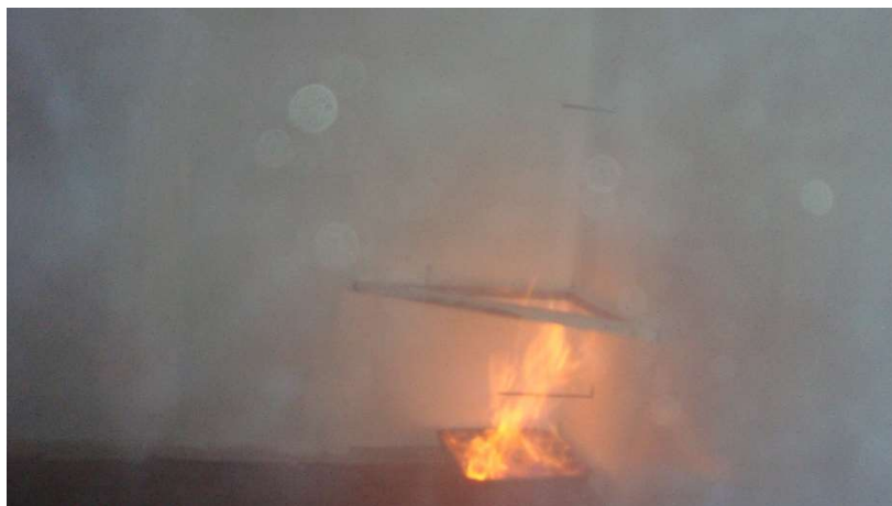
Fig. 22. Imagine după 30 de secunde de refulare a apei în incintă, la temperatura apei pentru suprimare de 40 °C
