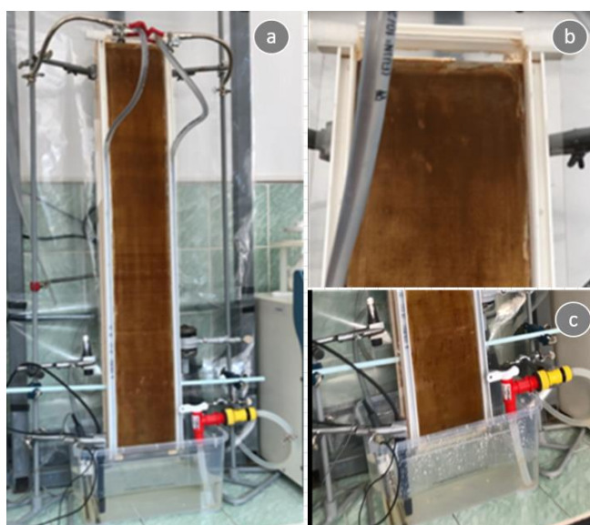
Figura 5.7. Stadiul coroziunii pe suprafața de tablă neagră de oțel în ziua III de studiu experimental
