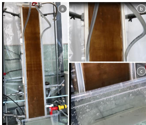
Figura 5. 9 Stadiul coroziunii pe secțiunea de tablă neagră de oțel în ziua V de studiu experimental
