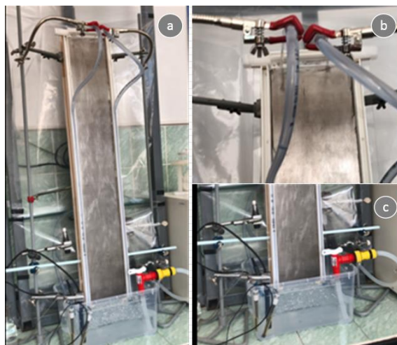
Fig. 5.4 Stadiu inițial la debutul experimentului: a)-secțiunea de tablă neagră de oțel fără coroziune; b)-vârf zona duze, inițial; c)-bazin de alimentare inițial.
