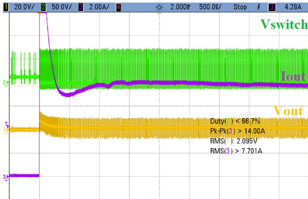
Figura 3.2.3. Scurtcircuit aplicat prototipului convertorului cu LT 3724
