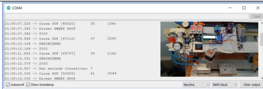
Fig. 6.21 Achiziția de date la 2 bar cu sarcina de 0kg pentru cilindru pneumatic 3
