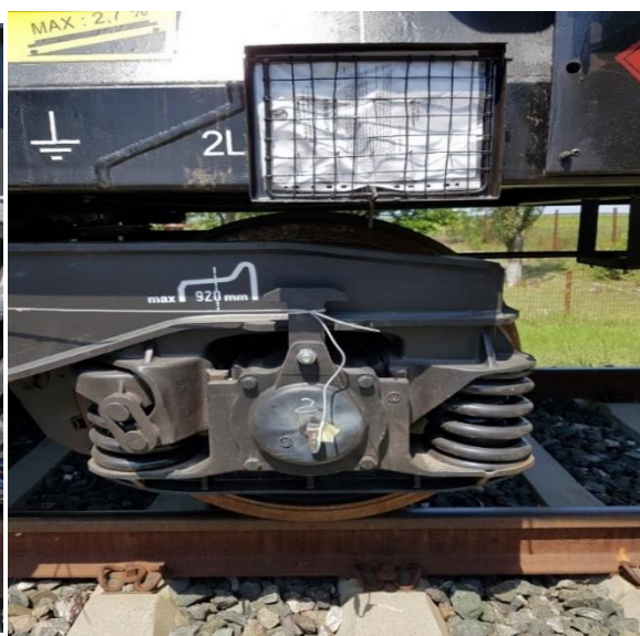
Fig.7.4. Acceleratorul montat pe doua osie primului boghiu
