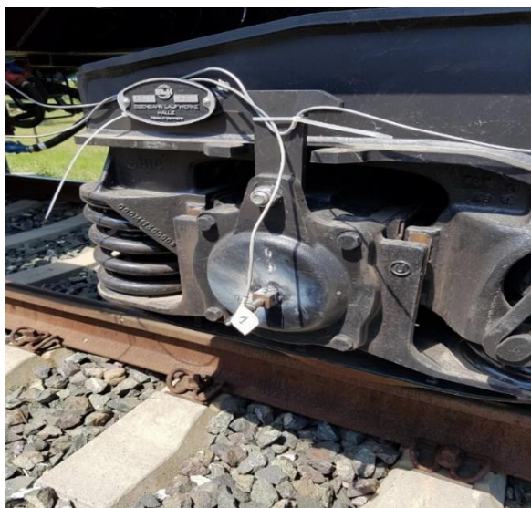
Fig.7.3. Acceleratorul montat pe prima osie a primului boghiu
