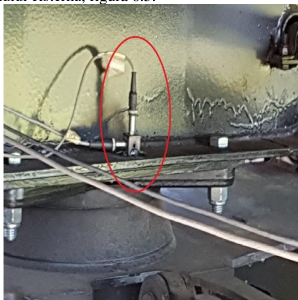
Fig.7.6. Accelerometrul 4 montat pe cutia vagonului în mijlocul primului boghiu
