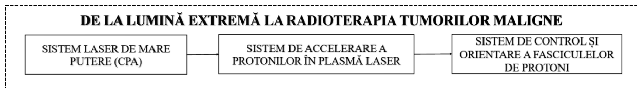
Fig. 5.1. Structura de principiu a acceleratorului de protoni în plasmă laser pentru radioterapia tumorilor maligne.
