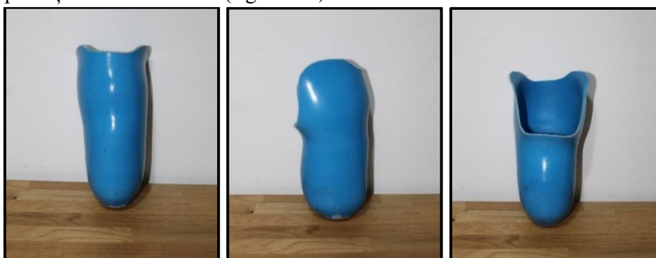
Figura 5.5. Manșonul de silicon personalizat obținut în urma procesului tehnologic.
