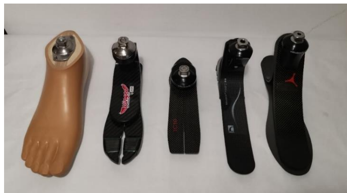
Figura 4.1. Picioarele protetice testate și evaluate în cadrul acestui studiu. De la stânga la dreapta: SACH (Ottobock), Balance Foot J (Ossur), Winged Foot (IB-ER Prosthetic), Terion 1C10 (Ottobock) Trias 1C30 (Ottobock).
