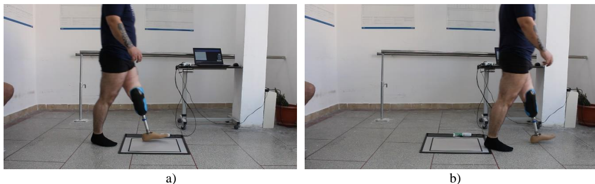
Figura 6.7. Începutul (a) și sfârșitul (b) ciclului de mers pentru piciorul protezat, înregistrat cu echipamentul MatScan (Tekscan)
