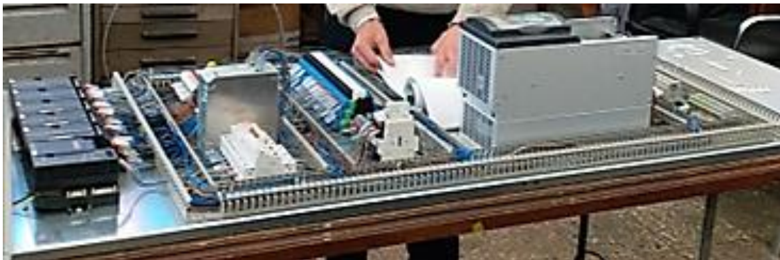
Fig. 13 – Execuția dulapului de automatizare în derulare, din laboratorul de Inginerie Electrică și Automatizări COMOTI
