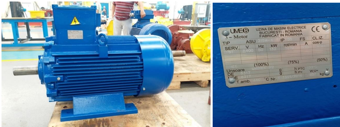
Fig. 6 – (stanga) Mașina electrică asu 315 m 132 kw (firma UMEB) / (dreapta) Eticheta cu caracteristicile sale
