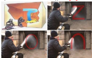
Fig. 2.4. Refularea jetului folosind tehnica literelor „T” [4], „Z”, „O”, „U întors” [42]
