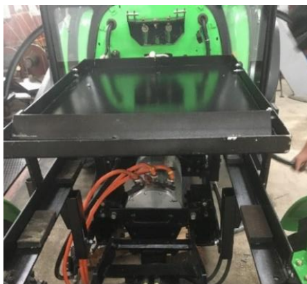
Figura 5.6 Suport baterie și sistem electronic de control finalizat
