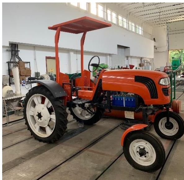
Figura 5.10 Tractor electric transportului
