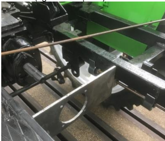
Figura 5.1 Sistemul de montaj al motorului electric la șasiul de tractor electric legumicol
