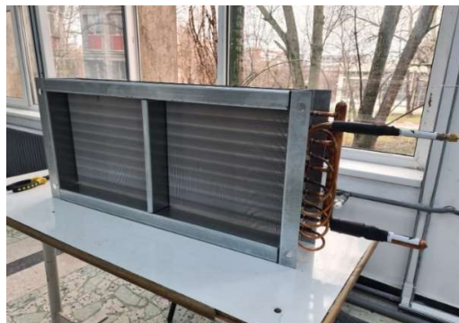
Fig. 4.1 Vaporizatorul din centrala de tratare a aerului
