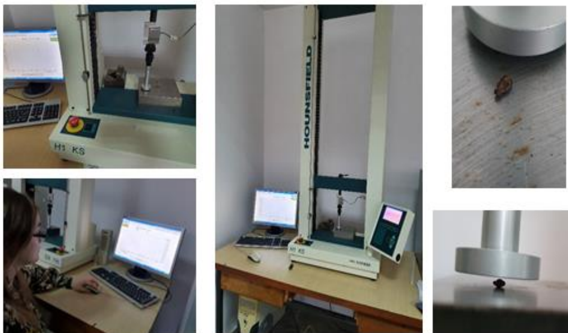
Fig.6. 8 Detalii din timpul procesului de compresiune a semințelor de struguri
