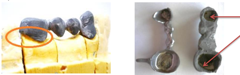
Figura 4.11. Identificarea de defecte la nivelul coletului
