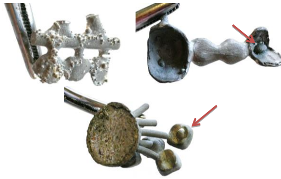
Figura 4.14. Plusuri sferice de la nivelul scheletelor metalice turnate
