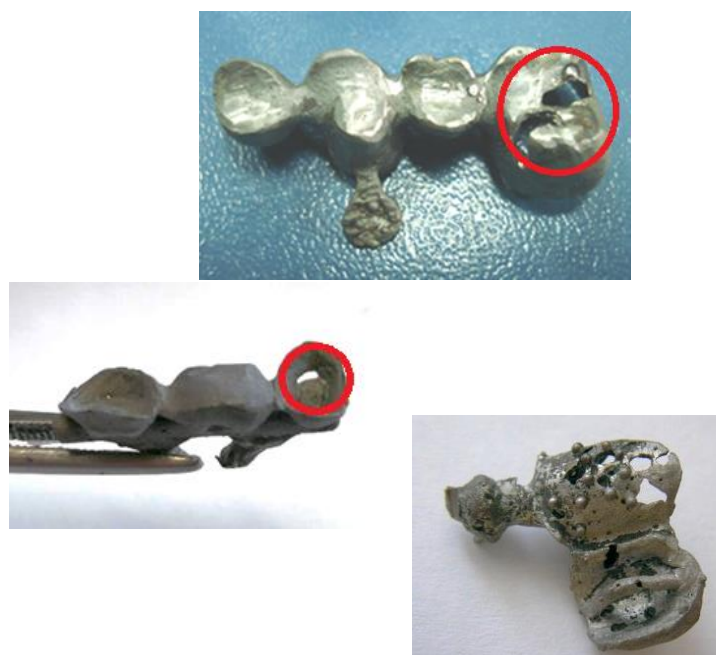
Figura 4.13. Lipsuri parțiale de la nivelul scheletelor metalice turnate
