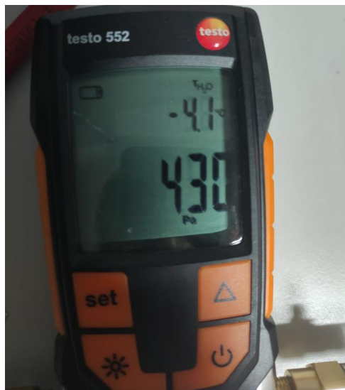
Fig.26. Aparat portabil care măsoară presiunea de vacuumare
