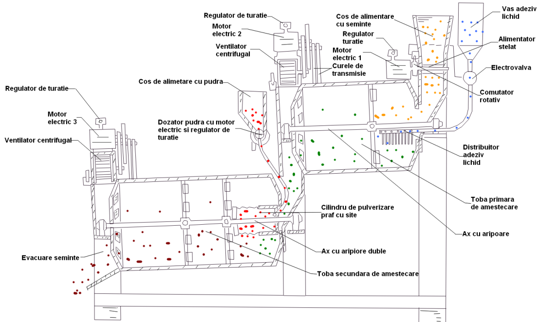
Fig.8. Schema de funcționare a mașinii de tratat semințe cu pulberi și lichide în două etape, după brevetul american cu numărul 4,465,017 din 1984 al John J. Simmons, [14].
