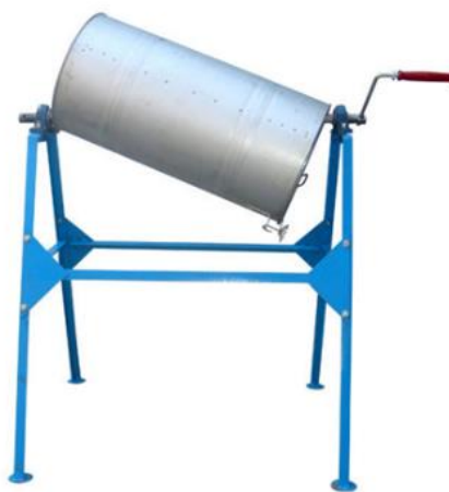
Fig. 4. Aparat de tratat semințe operat manual, [11]
