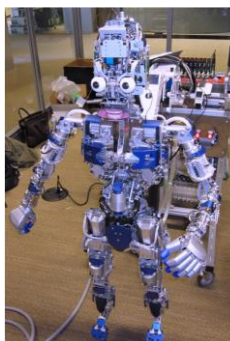
Figura 1.2. Robotul umanoid "Kokoro" distribuitori proporționale FESTO de tip MPYE pentru servo-actuatorile electropneumatice, [103]
