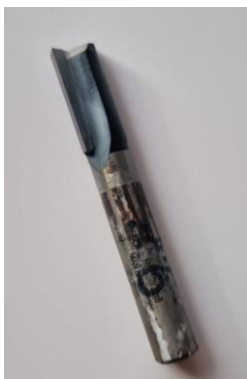
Fig. 7.1. Freză cu două caneluri cu diametrul de 10 mm.
