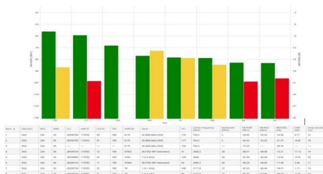
Figura 7.29. NB-RSRP, NB-RSRQ și alte date privind conexiunea descendentă Digi Mobil în punctul de monitorizare radio, obținute cu platforma de monitorizare Nestor.
