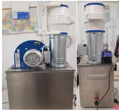
Fig. 17 Realizarea ansamblului sistemului de filtrare a aerului industrial bazat pe fenomenul de cavitație ultrasonică : a - vedere frontală ; b - vedere laterală
