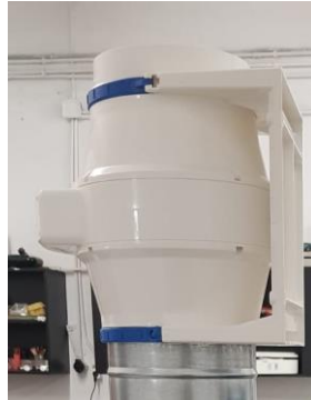
Fig. 16 Ventilatorul pentru extragerea aerului filtrat de la suprafața lichidului din cuva de filtrare
