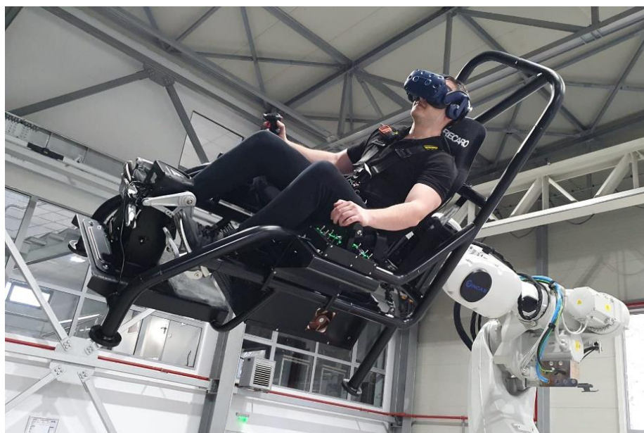
Figura 3.1 Sistem de simulare dinamică pentru aplicații de tip pilot-in-the-loop, Credit: INCAS
