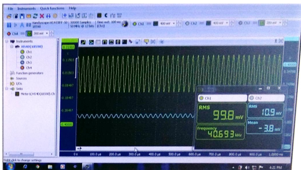
Figura 9.2 Detaliu al ecranului osciloscopului digital cu determinarea frecvenței de rezonanță 40693 kHz
