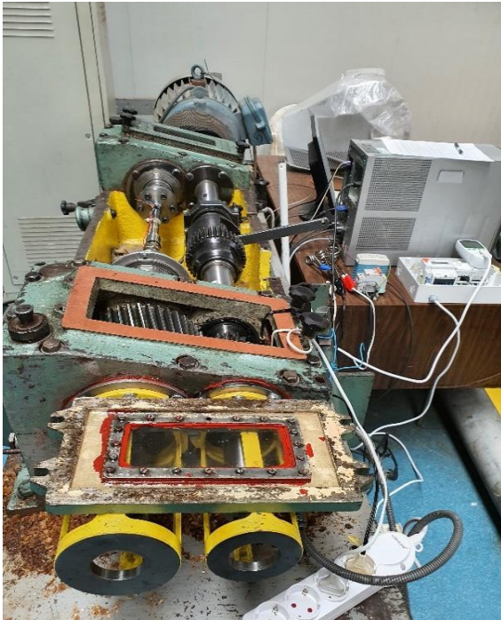
Fig. 5.11. Standul de încercat roți dințate și testare a lubrifianților echipat cu rezistențe electrice, priză cu contor digital de energie și variator de tensiune.
