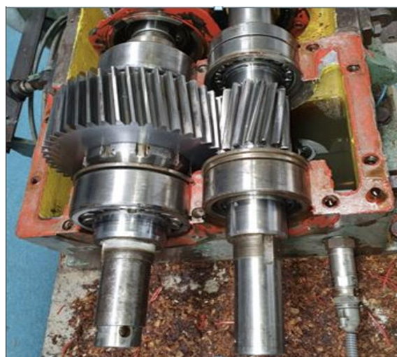
Fig. 2.43. Semicarcasa inferioară, cu angrenajul montat, realizat la Uzina mecanică Cugir
