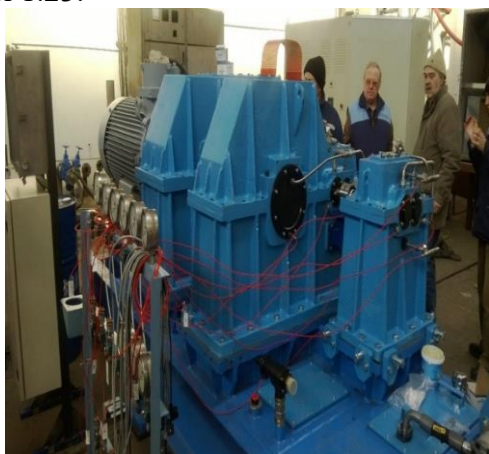
Fig. 1.22. Stand de testare roți dințate ESPOSA – INCDT-COMOTI, (dupa Gabroveanu, 2016) [15]
