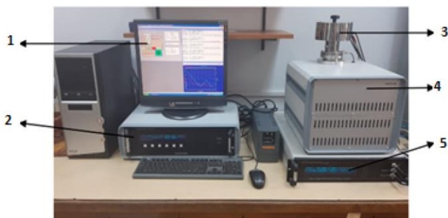
Fig. 6.1. Spectrometru dielectric 1 - PC; 2 - Unitate centrală; 3 - Celulă de măsurare; 4 - Sistem de control al temperaturii NovoTherm; 5 - Unitate de comandă.
