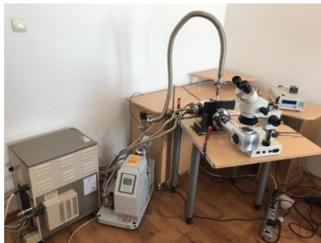
Figura 2.1: Sistem de masurare a senzorilor de temperatura utilizat in laborator
