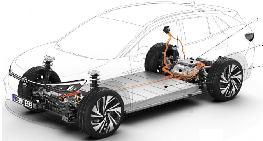
Figura 2.5. Arhitectura autovehiculului VW ID.4, [13]:
