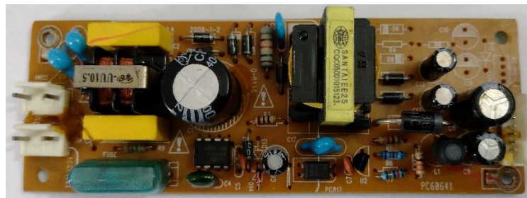
Fig. 2.4 Sursă de alimentare în comutație
