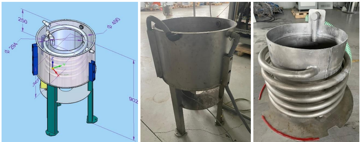
Figura 3.5. Proiectare CAD și construcție - cuvă cu sistem de răcire și recirculare a electrolitului
