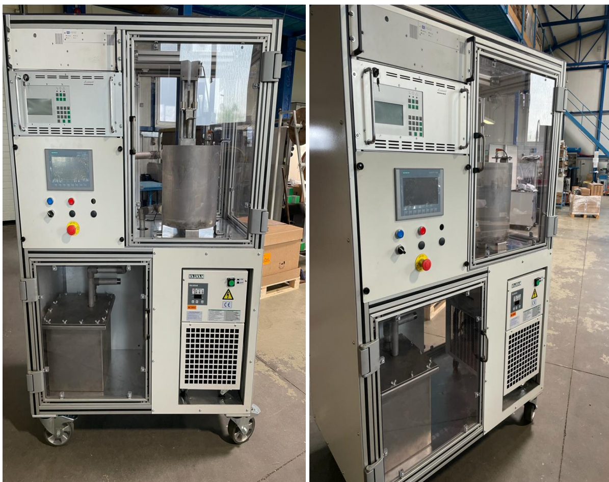
Figura 3.2. Imagini ansamblu - Instalația de oxidare în plasmă electrolitică construită
