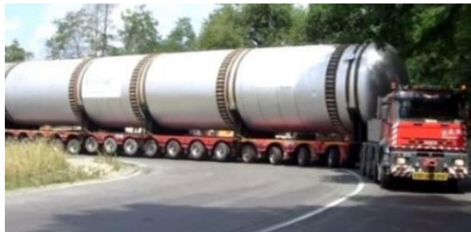
Fig. 1. 1. Transportarea rutieră a unui echipament agabaritic
