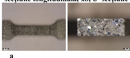
Fig. 3.21-Aspectul macroscopic al epruvetelor de tracțiune din ZnMgFe după recoacere la 400°C/ 5h: a- secțiune longitudinală, x8; b- secțiune transversală, x40
