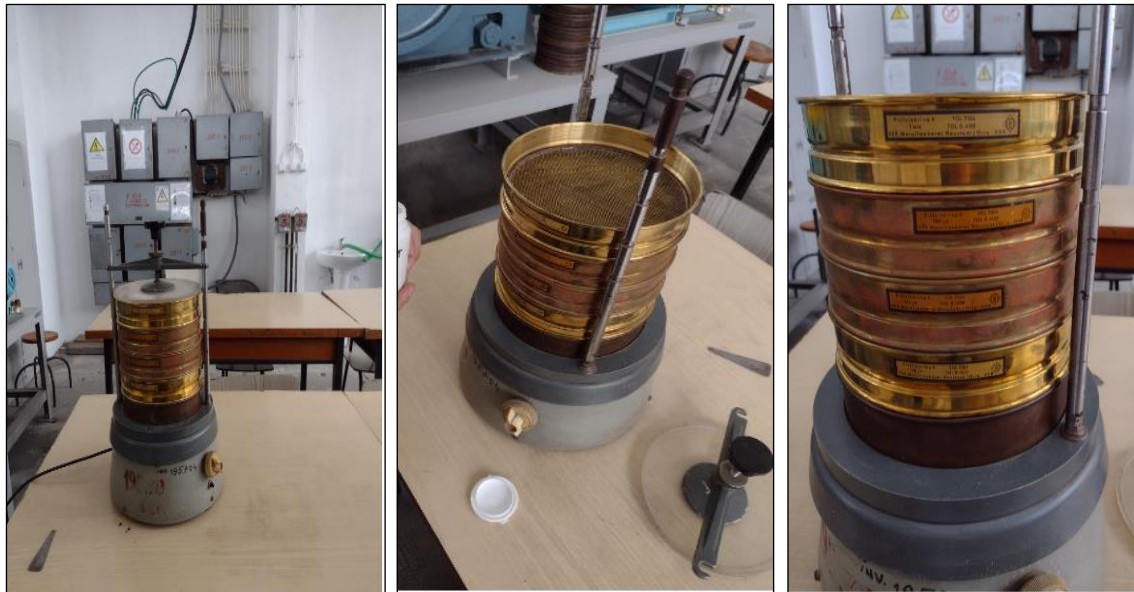
Fig. 5. 2. Imaginea aparatului de cernere prin vibrație cu 4 site standardizate
