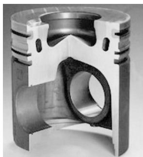
Figura 2.4. Piston din compozit cu matrice de aluminiu armată cu fibre scurte, pentru motoare Diesel [12].
