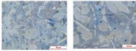
Fig. 7.22- Aspecte structurale ale aliajului ZnCu, stare turnat (proba martor): a- x500; b- detaliu al imaginii a (x1000)
