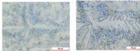
Fig.7.23 Aspecte structurale ale aliajului ZnCu, stare turnat și omogenizat la 300°C/5ore: a- x500; b- detaliu al imaginii a (x1000)
