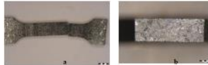
Fig. 6.18-Aspectul macroscopic al epruvetelor de tracțiune din ZnCuMg, după recoacere la 300°C/ 5h: a)- în secțiune longitudinală, x8; b)- în secțiune transversală, x40
