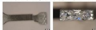
Fig. 6.15-Aspectul macroscopic al epruvetelor de tracțiune din ZnCu, după recoacere la 400°C/ 5h: a)- în secțiune longitudinală, x8; b)- în secțiune transversală, x40
