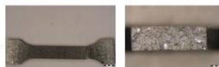
Fig. 6.20-Aspectul macroscopic al epruvetelor de tracțiune din ZnCuMg, după recoacere la 350°C/ 5h: a)- în secțiune longitudinală, x8; b)- în secțiune transversală, x40
