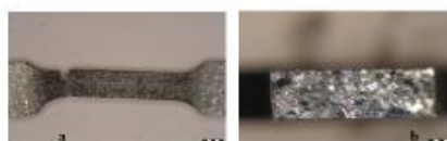
Fig. 6.14-Aspectul macroscopic al epruvetelor de tracțiune din ZnCu, după recoacere la 300°C/ 10h: a)- în secțiune longitudinală, x8; b)- în secțiune transversală, x40
