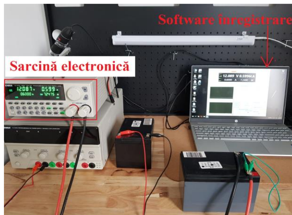
Fig.5.2. Ansamblu experimental folosit la efectuare testului de descărcare la curent constant
