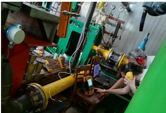
Figura 55. Vizualizarea și înregistrarea răspunsului piezoelectric pe scopometru
