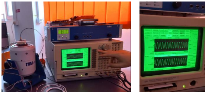
Figura 20. Teste experimentale afișând răspunsul sinusoidal în timp
