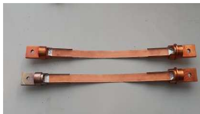
Fig. 19. Conductorii HTS fără carcasă realizați cu plita termostată.
