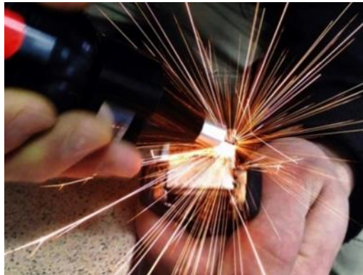
Figura 4.2. Procesul de depunere electrică prin scânteiere utilizând aplicatorul miniatural 4
