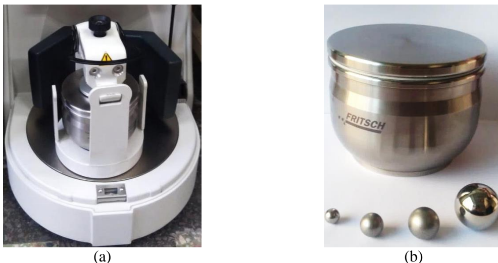
Figura 5.1. Fritsch® Pulverisette 6 Classic Line a) moară planetară și b) incintă și bile din oțel inoxidabil.
