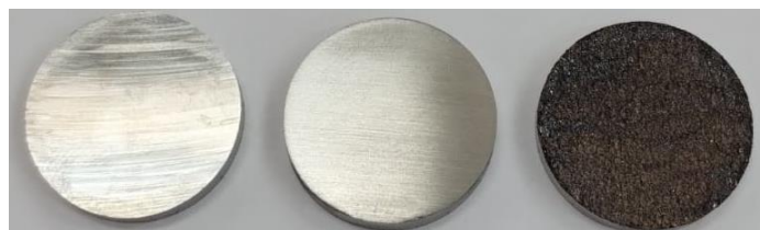
Figura. 7.3 Etapele acoperirii propriu-zise cu CoCrMoNbTi HEA unde în stânga este substratul brut, mijloc substratul pregătit și dreapta substratul acoperit prin tehnica ESD 15
