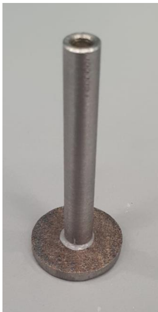
Figura 8.3. Tija de prindere fixată cu adeziv de proba testată 20
