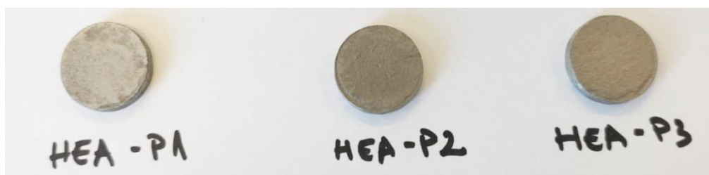
Figura 6.4. Imagini macroscopice ale probelor de HEA sinterizate obținute prin varierea parametrului temperatură 12
