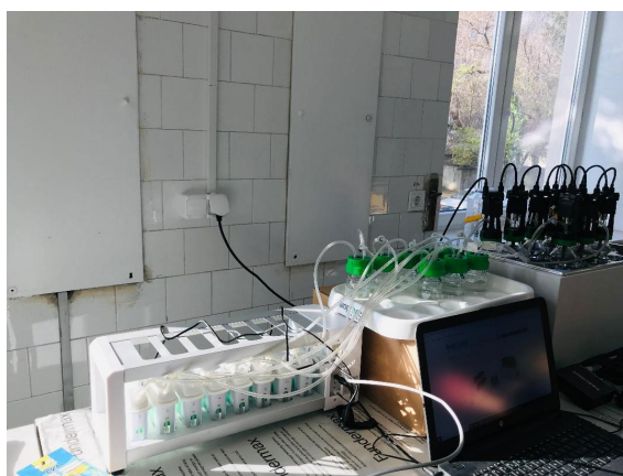
Fig. 5.7. Digestie anaerobă - experiment la scară de laborator [68]
