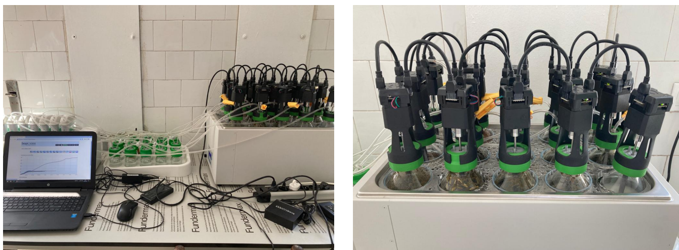
Fig. 5.2. Amestecuri optime de dejecții animaliere și subproduse agroalimentare pentru a obține biogaz folosind Gas Endeavour
