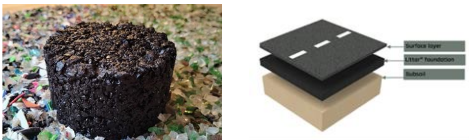
Fig. 5.1. (a): Eșantion de testare cilindric Littar® – (b): Littar® într-o structură rutieră optimă – preluare [66]
