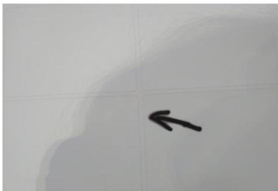
Fig. 2.22. Pentru identificarea defectului, nu s-a îndepărtat deșeul de pe materialul ștanțat [37].
