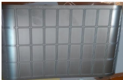
Fig. 2.1. Geometria unei ștanțe cu care se obțin etichete autocolante dreptunghiulare [31].
