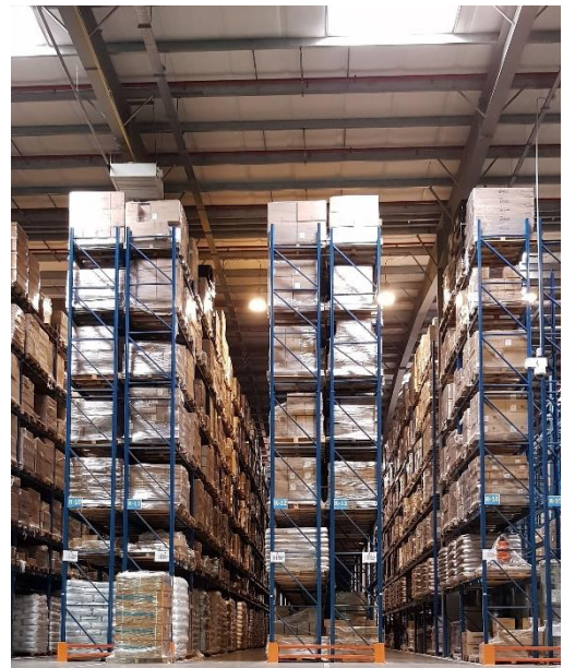
Fig. 1.2. Sisteme de rafturi selective. Sursă foto – depozit Euroccoper S.A.
