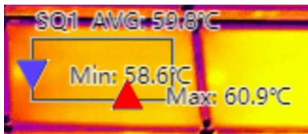
Figura 4.5 Valorile temperaturii pe un panou sănătos
