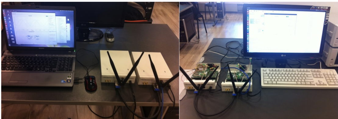
Figura 2.11 Transmisie și recepție 2 x 2 MIMO [8]
