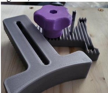
Fig.3.8. Asamblarea mecanismului de sprijinire – față
