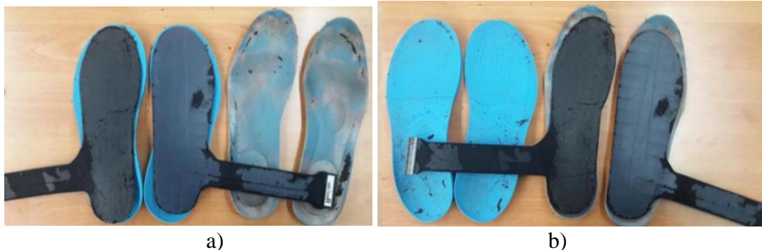
Fig.7.7. Sistem de măsurare a presiunii In-Shoe Pedar: a) Talonete imprimate cu Filament 82A, albastru (stânga); b) Talonete originale ale încălțăminte (dreapta).
