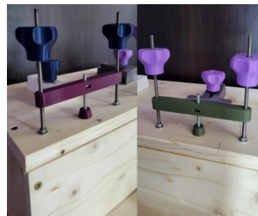
Fig.3.9. Asamblarea platbandei, mânerelor și a calapodului
