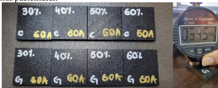
Fig.6.6. Filaflex 60A – speciunile și măsurarea acestora cu durimetrul Shore A
