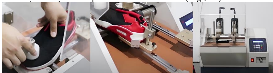
Fig.3.2. Mașina de verificare a durabilității pantofilor GT-KA01-2B [76]
