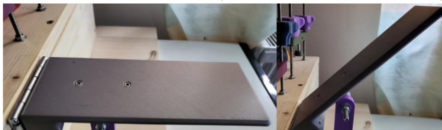
Fig.3.12. Suprafața de așezare la 0° și la 45° față de planul de așezare
