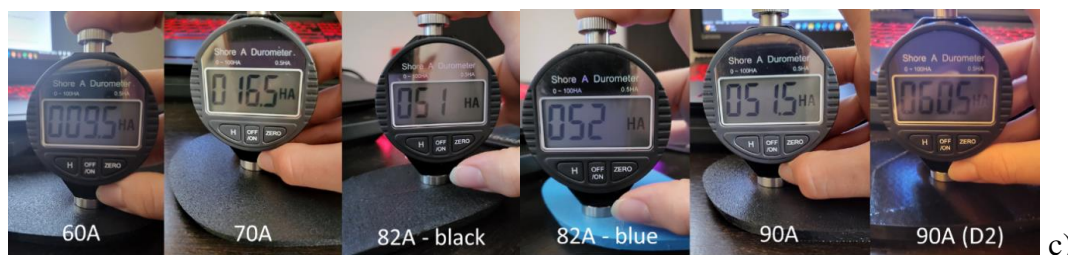
Fig.7.8. Măsurarea durității talonetelor varioShore: a) design 1; b) design 2; c) celelalte materiale.
