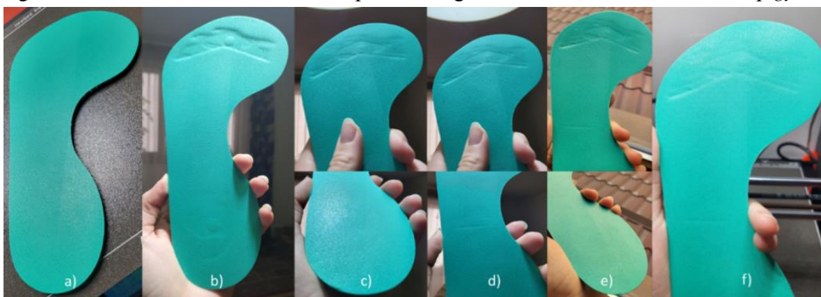
Fig.7.11. Evoluția talonetei din VarioShore 1 după: a) imprimare; b) 7,000 de cicluri; c) 42,000 de cicluri; d) 63,000 de cicluri; e) 98,000 de cicluri; f) 48 de ore.
